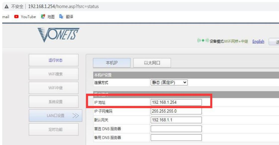
3、此时，与网桥/模块连接的终端电脑，需设置一个与其相同网段的 IP 地址：
