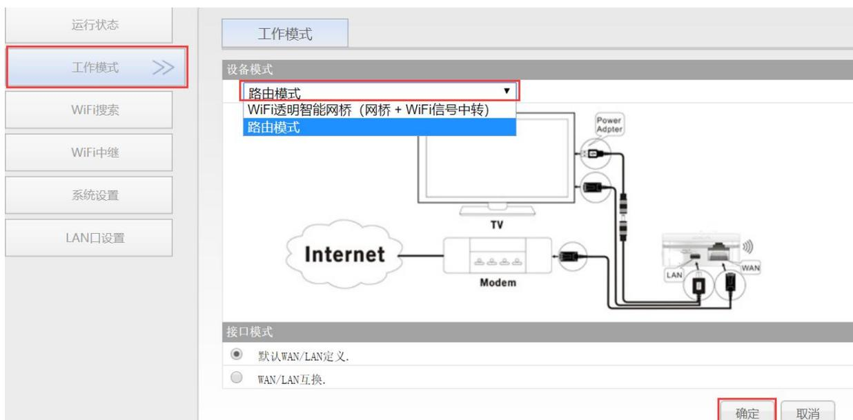
5. 重启设备：切换到“系统设置”下的“设备重启”，点击“重启”按钮，VONETS 设备会自动切换到路由模式；
