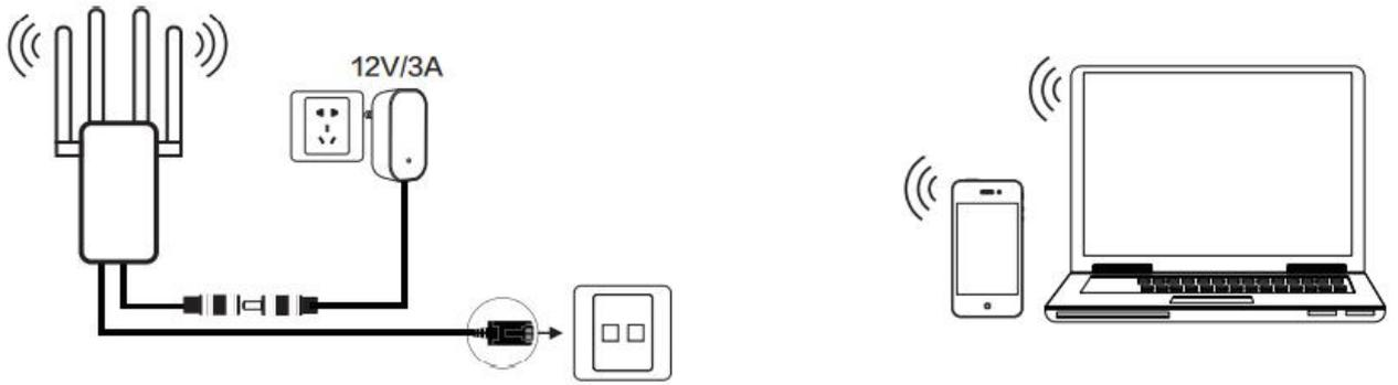
1.2 路由模式（在实际应用环境中，POE 输出口（PSE）若连接非 POE 网口（PD 即接入网口），请务必谨慎使用，须确保接入网口与电源地隔离，否则可能造成接入设备的损坏！）
